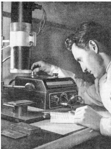
Abb. IV.2: Bestimmung der Dicke von Lackschichten durch Rückstreumessungen mit  $^{204}\text{Thallium}$
