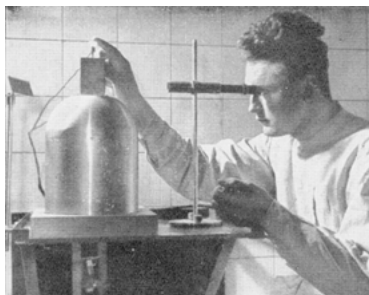
Abb. IV.4: Aufladung einer Aluminiumionisationskammer, Beobachtung der durch ein Betastrahlpräparat hervorgerufenen Entladegeschwindigkeit am Goldblattelektrometer mit Ablesefernrohr
