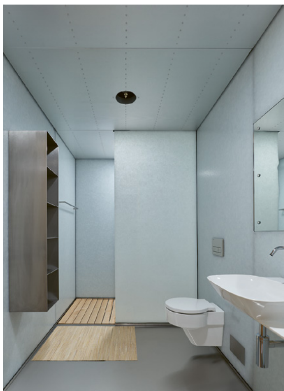
ABB. 13 Badezimmer der UMAR-Unit mit einer Wandverkleidung aus wiederverwerteten Windschutzscheiben
