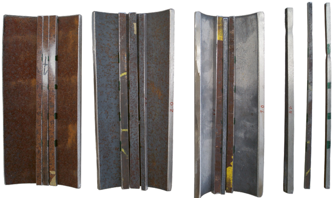
ABB. 13 Aus den »geretteten« Rohrquerschnitten wurde eine Vielzahl von Prüfmustern geschnitten und auf ihre Stahlqualität getestet.
