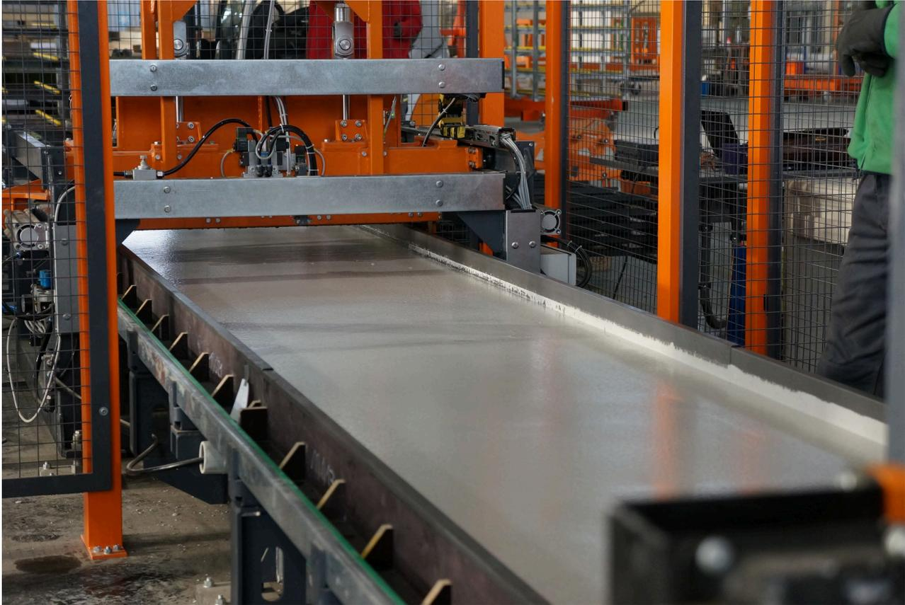
Abb. 16: Co-Extrusions-Technologie, Aeroleichtbeton © G.tecz Engineering GmbH
