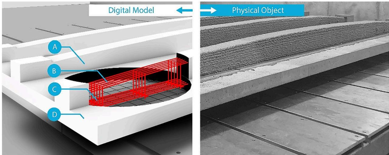
Abb. 9: Kombiniertes Fertigungsverfahren einer Betonfertigdecke mit dem SC3DP Verfahren
