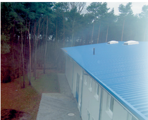
Abb. 2.268 ■ Nebelaustritt bei der Luftdichtheitsprüfung
