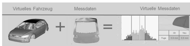
Bild 1: Virtuelle Messdatenanalyse: Kopplung eines virtuellen Fahrzeugmodells und der realen Messwerte
