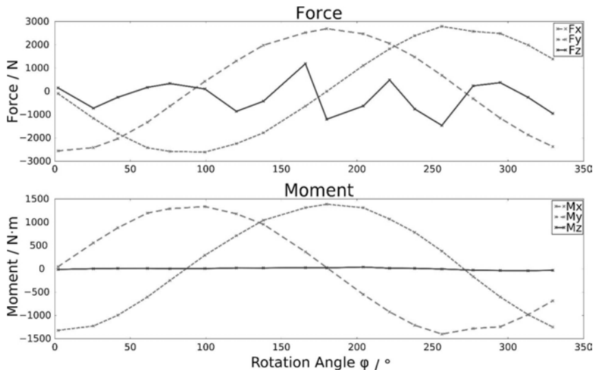
Bild 3: Kartesische Komponenten der Kraft- und Momentenvektoren im Anlagenkoordinatensystem
