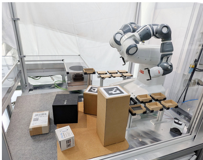
Bild 4 Links: CNC-gesteuerte Roboterzelle bei der Ausführung einer Handhabungsaufgabe. Rechts: ROS-Modell der Roboterzelle mit dem Transportsystem "XPlanar". Foto bzw. Grafik: ISW Uni Stuttgart
