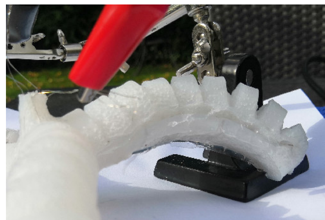
Bild 15. Verformung des EAP-Greifers. Grafik: KTMfk
