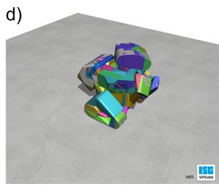
Bild 5. Beispielhafte Darstellung mehrerer Hüllkörper mit und ohne konvexe Zerlegung in ISG-virtuos. Grafik: ISG
