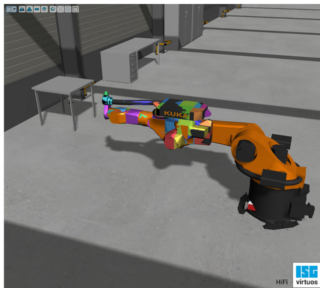
Bild 6. Darstellung der konvexen Zerlegung am Beispiel einer Teilgeometrie eines Industrieroboters. Grafik: ISG
