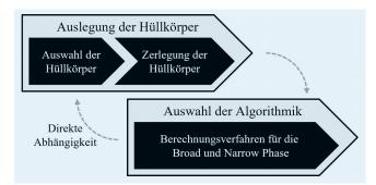
${\bf Bild~2}.$  Schritte bei der Auslegung von Kollisionsmodellen für die virtuelle Inbetriebnahme. {\it Grafik: ISW}
