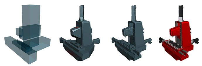
Bild 1. Darstellung verschiedener Hüllkörper am Beispiel einer Fräsmaschine. Grafik: ISW
