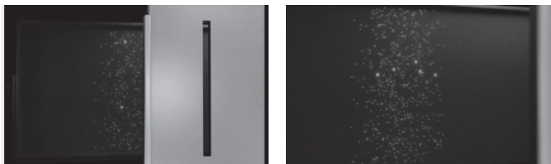
Abb. 5 & 6: Schirm beim Experiment mit einem Spalt. Die einzelnen Ereignisse streuen im Bereich eines Balkens mit unscharfen Grenzen
