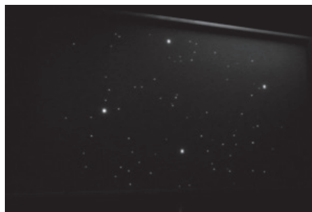
Abb. 4: Schirm beim Experiment ohne Spalt. Die einzelnen Ereignisse streuen auf dem ganzen Schirm 16
