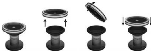
Bild 6: Messablauf. Nach der Messung (gemäß Bild 5) der Oberseite inklusive Referenzflächen wird der Halter manuell herumgedreht und anschließend die gleiche Messprozedur auf der zweiten Seite durchgeführt.
