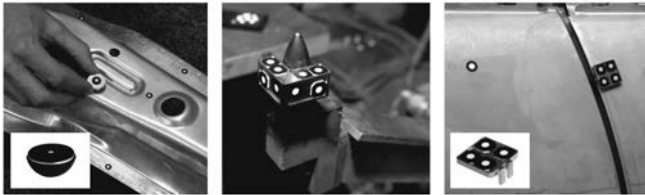
Bild 12: Einsatzfertige Adapter zur optischen Erfassung mechanischer Größen z.B. Bohrungen, Bolzenachse und Kanten
