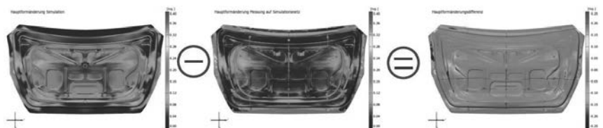
Bild 14: Flächenhafter Vergleich der Hauptformänderung zwischen Simulationsergebnis (links) und ARGUS Messergebnis (Mitte), rechts ist die Differenz dargestellt.
