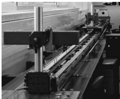
Bild 8: Messung einer Linearführung mit 6 m Positionierbereich (links); Messung an einem luftgelagerten Präzisionsplanartisch mit einem Verfahrbereich von 400x400 mm 2 (rechts)
