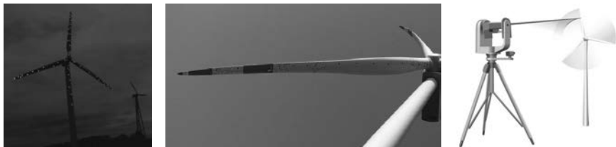
Bild 2: Vermessung von Windenergieanlagen; links: WEA beklebt mit photogrammetrisch beobachteten Retromarken [11]; Mitte: am Rotorblatt angebrachtes Punktemuster, rechts: Laservibrometer mit kombinierter Kamera zur Erfassung von Schwingungen [15]
