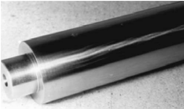
Bild 5: Beispiel einer welligen Oberfläche beim Rundschleifen
