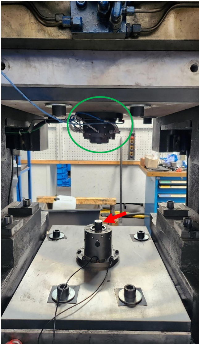
Bild 3. Presseninnenraum mit verbauten Gesenken und Sensoren. Foto: IPH
