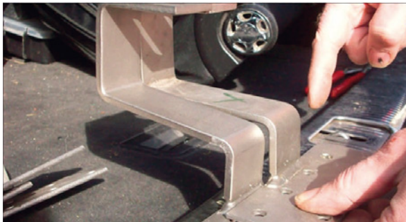
Abb. 1: Verbogene Dachhaken durch starke Schneelast
