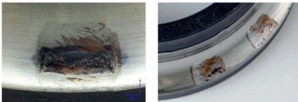
Abbildung 5 Fretting Corrosion auf der Inneringlaufbahn eines Schrägkugellagers
