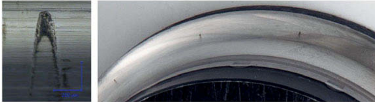
Abbildung 4 False Brinelling auf der Inneringlaufbahn eines Schrägkugellagers
