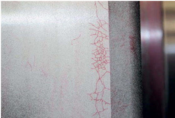
Bild 2: Rissnetzwerke am Übergang von der Aufschiebeschräge zur Laufbahn eines Zylinderrollenlagerinnenrings nach dem Fertigschleifen
