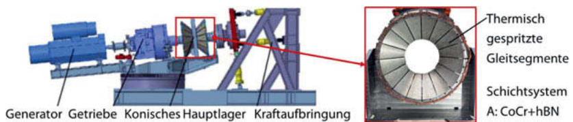
Bild 8: Momentengleitlagerprüfstand mit thermisch gespritzten Gleitsegmenten, nach [9]
