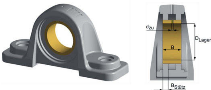
Abbildung 1: Bronzegleitlager in einem Gusseisengehäuse
