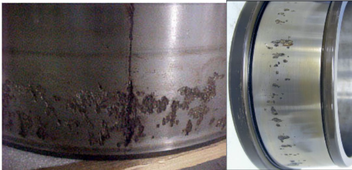
Bild 5: Großflächiger Oberflächenschaden verursacht durch eine defekte Lünette der Schleifmaschine aus Bild 4 (linkes Bild) sowie im Vergleich dazu ein Kegelrollenlagerinnenring mit dem Schadensbild WEC aus einem Windanlagengetriebe (rechts Bild).
