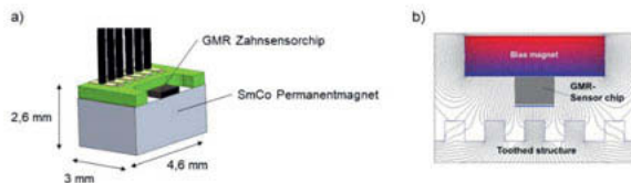
Bild 2: (a) GMR-Zahnsensormodul (Bildquelle: Sensitec GmbH) (b) Funktionsprinzip des Zahnsensormoduls (Bildquelle: Sensitec GmbH)
