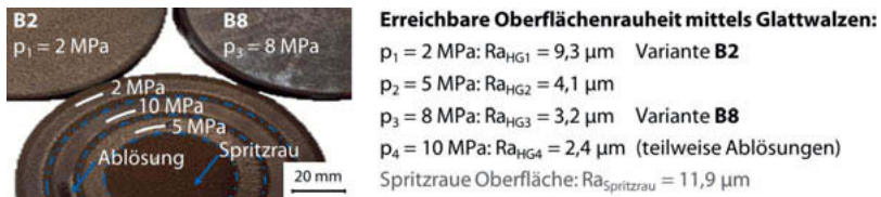
Bild 3: Hydrostatisch glattgewalzte Schichtvariante B
