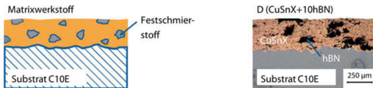
Bild 2: Thermisch gespritztes Matrixwerkstoffkonzept schematisch (links) und als Querschnitt eines beispielhaften Schichtsystems (rechts)
