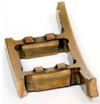
Bild 1: Axialschliff mit „White Etch Cracks“ [2] (links) und Käfigschaden infolge Schlupfzusammenbruch [3] (rechts).
