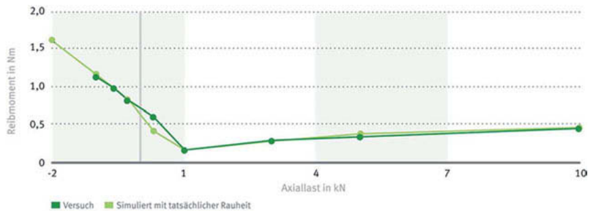
Bild 6: Vergleich des simulierten und des am Prüfstand gemessenen Reibmoments für die neue ARU-Lagerbauform
