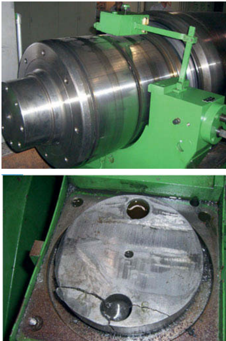
Bild 4: Walze zum Schleifen mit der Innenringlaufbahn in die Lünettenaufnahme gesetzt (Bild links) sowie die durch Stoßschäden zerstörte Gleitlagerschale der Lünette aus dieser Maschine.
