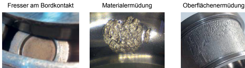
Bild 3: Relevante Schadensmechanismen des Lagers in der Applikation
