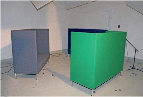
Abbildung 3.10 Messung im Hallraum von schallabsorbierenden Sitzmöbeln [Quelle: SMV Sitz- und Objektmöbel GmbH]
