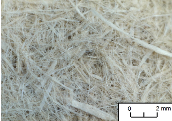
Abbildung 3.7 Großaufnahme von Holzwolle als Beispiel eines porösen Absorbers
