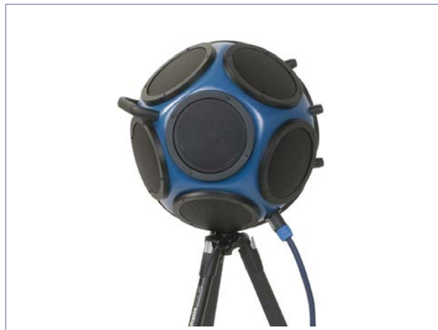
Abbildung 4.7 Normgerechter Lautsprecher (Dodekaeder) nach DIN EN ISO 3382-1 [69] [Quelle: Norsonic-Tippkemper GmbH]
