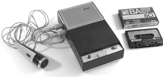
Abb. 1: Philips EL 3301/22T (Nr. 566488, Baujahr vermutlich 1966) mit Mikrofon EL3797 und Compact Cassette (aus späterer Zeit). Eines der beiden Mikrofonkabel dient der Fernsteuerung. Zentrum für Populäre Kultur und Musik, Audiogerätesammlung, Leihgabe Rogoll.
