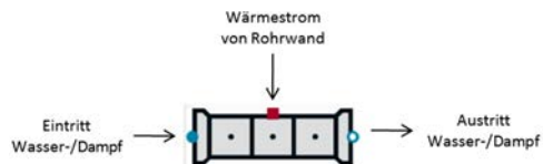
Abbildung 4.5: Komponentenmodell eines Rohres (ohne Rohrwand) in der ClaRa -Bibliothek nach [68]
