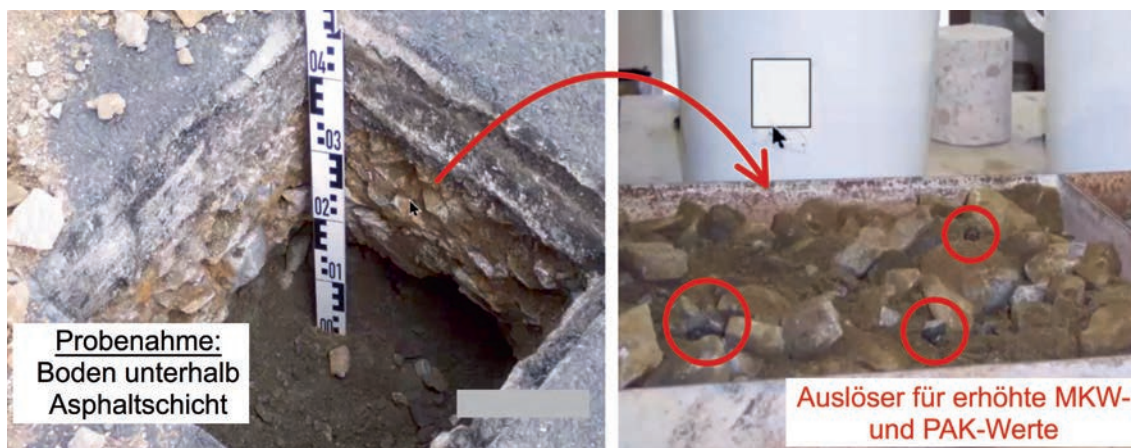
Abbildung 5 Fehlerhafte Untersuchung und Falschinterpretation durch unbrauchbare Probeentnahme (12)
