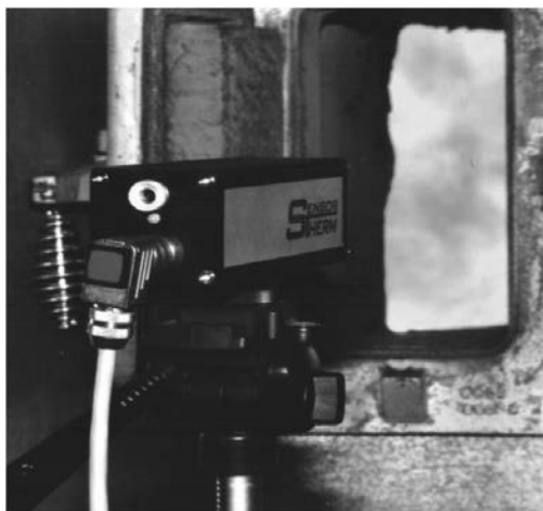
Bild 4: Temperaturmessung mit einem Strahlungsipyrometer Metis MY 47
