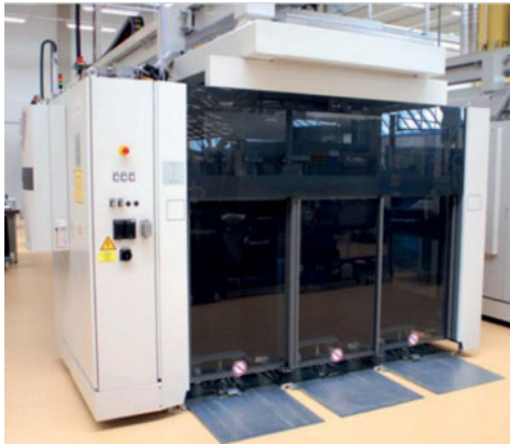
Abbildung 7-2: Beladeportal mit eingeschobenen Korbstapeln [13]
