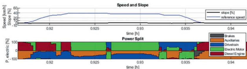
Abbildung 7: Leistungsaufteilung über einem Teilszenario bestehende aus einem Beschleunigungs-, Konstantfahrt- und Abbremsvorgang
