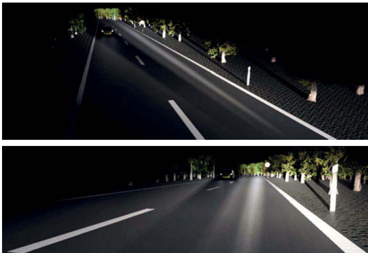
Bild 6: Visualisierung der Ausleuchtung des digitalisierten rechten Scheinwerfers.
