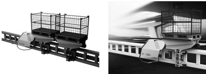
Bild 8: Spike Cargo in unterschiedlichen Systemvarianten für den innerbetrieblichen Materialtransport
