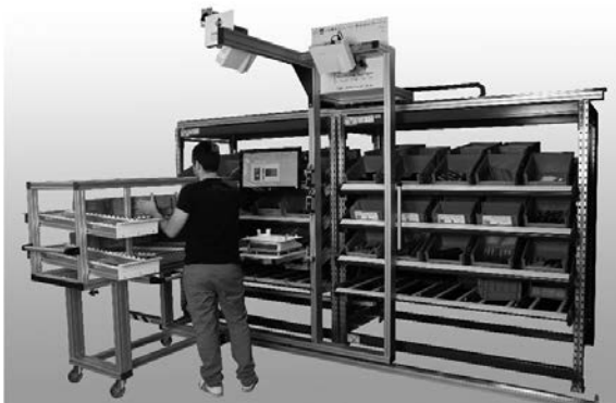
Bild 1: Prototyp des Assistenzsystems für manuelle Kommissionierprozesse
