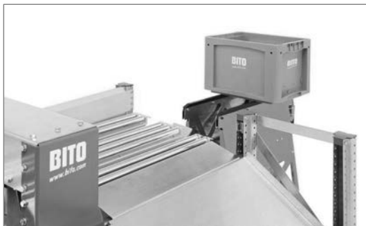
Bild 6: KammLAM : Eingangsseite der Lastübergabestation mit davor befindlichem FTF und Behälter auf Auflagegesteg des FTF
