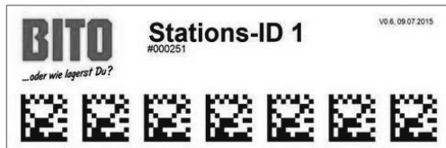
Bild 4: Beispielhafter optischer Marker zur Anbringung neben der Fahrspur
