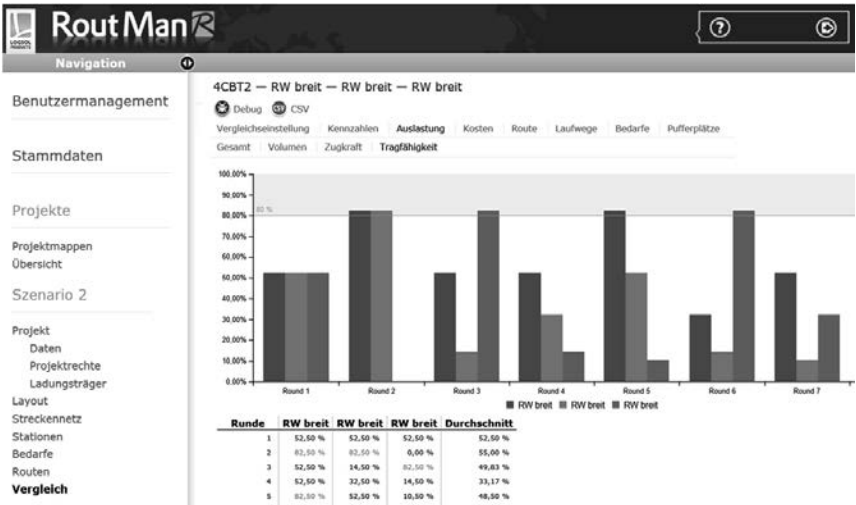
Bild 6: Softwaregestützte Auswertung zur Auslastung der Tragfähigkeit (Zahlen verfremdet)
