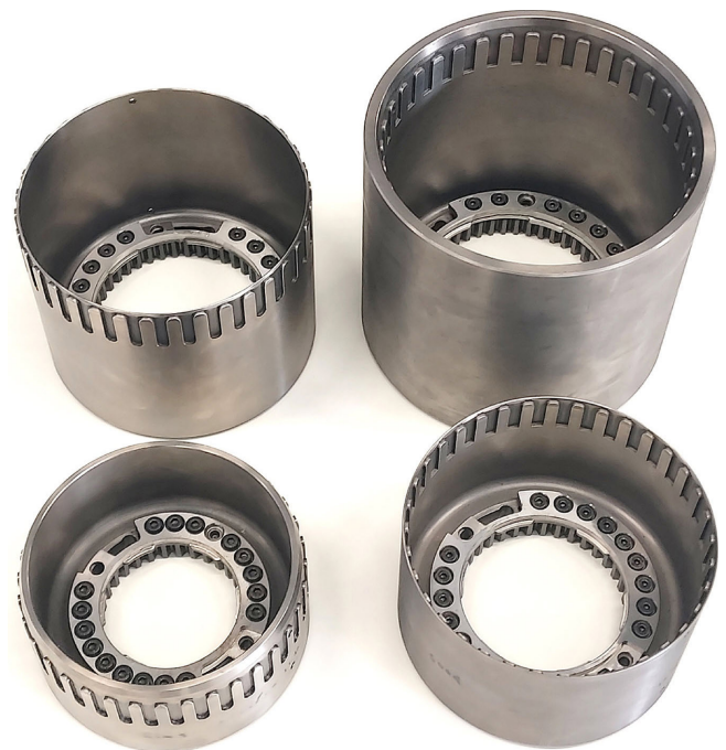
Bild 2 Demontierter Werkzeugsatz zum simultanen Twisten eines Hairpin-Stators mit vier Drahtlagen. Die vier topfförmigen Werkzeuge werden für den Prozess konzentrisch geschachtelt. Foto: wbk
