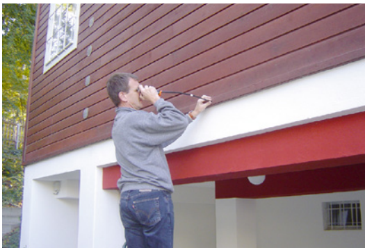
Abb. 43: endoskopische Nachbegutachtung der Schadensgrenze
