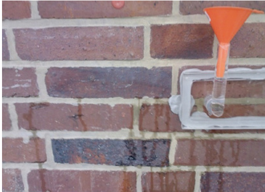
Abb. 13: Beprobung einer Musterfläche mit Neuverfugung – Wasseraustritt aus den Fugen
