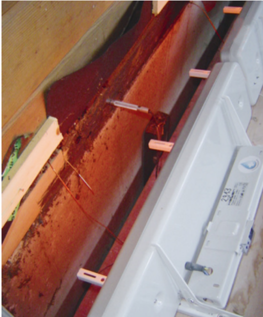
Abb. 38: Infraroterwärmung von der Außenseite mit sichtbaren Temperatursensoren
