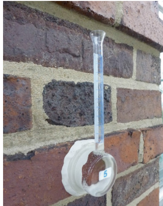
Abb. 3: Untersuchung der Wasseraufnahme mit dem Karstenschke Prüfröhrchen (hier an einem Ziegel)
