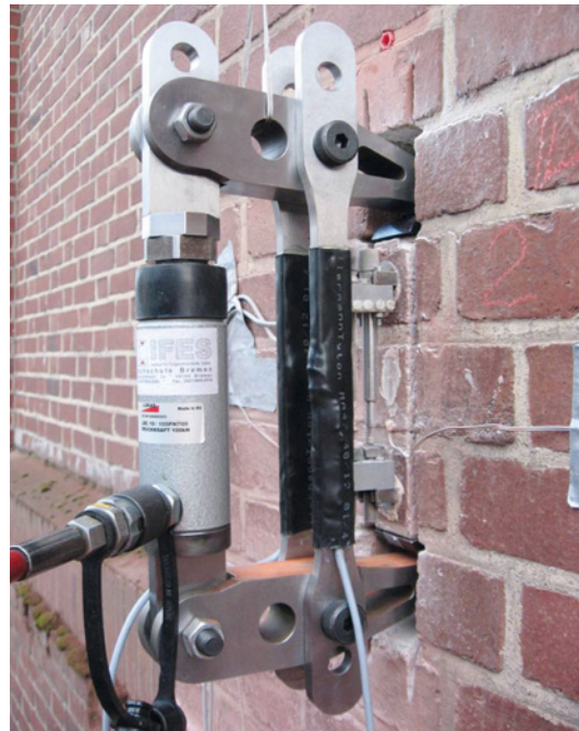
Abb. 8: Prüfzange des Freischneideverfahrens während der Prüfung (Quelle: www.hs-bremen.de)
