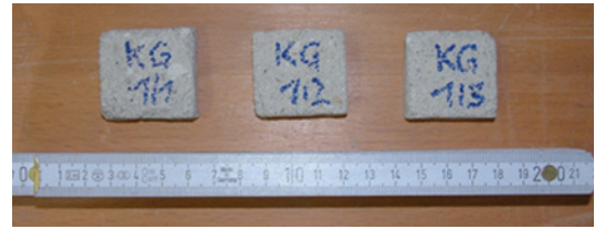
Abb. 17: Probekörper nach DIN 18555-9, Verfahren III
