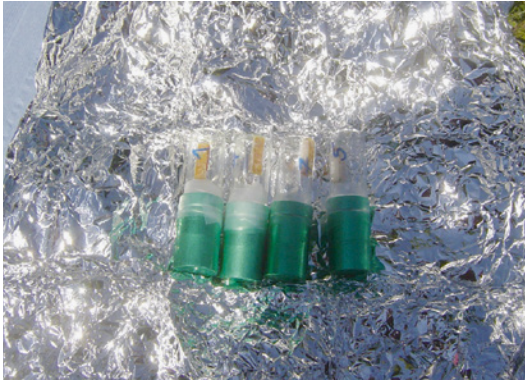
Abb. 41: im Labor steril konfektionierte Mycelproben des Echten Hausschwamms (BAM 315)
