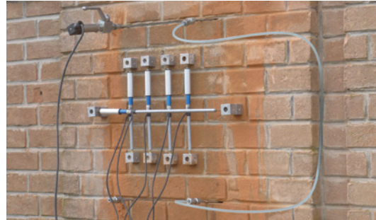
Abb. 7: Flat-Jack-Verfahren beim Einsatz am Mauerwerk (Quelle: www.expin.it)
