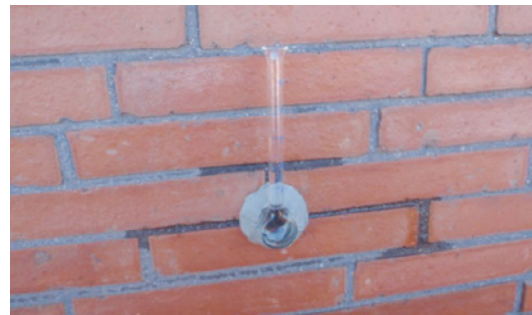
Abb. 4: Untersuchung der Wasseraufnahme mit dem Karstenschke Prüfröhrchen (hier an einer Fuge)
