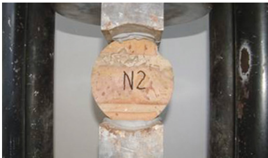
Abb. 14: Prüfkalotten mit eingegipstem Probekörper
