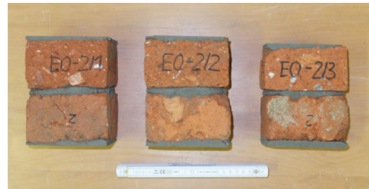
Abb. 16: Probekörper nach DIN 105-1
