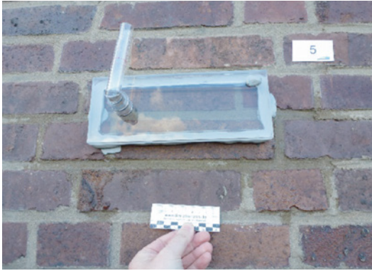
Abb. 5: Untersuchung der Wasseraufnahme mit der WA-Platte nach Franke
