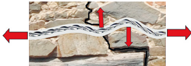
Bild 6.11 Wirkung von Umlenkkräften bei Zug im verformten Spiralanker (Ausschnitt aus Bild 6.10)
