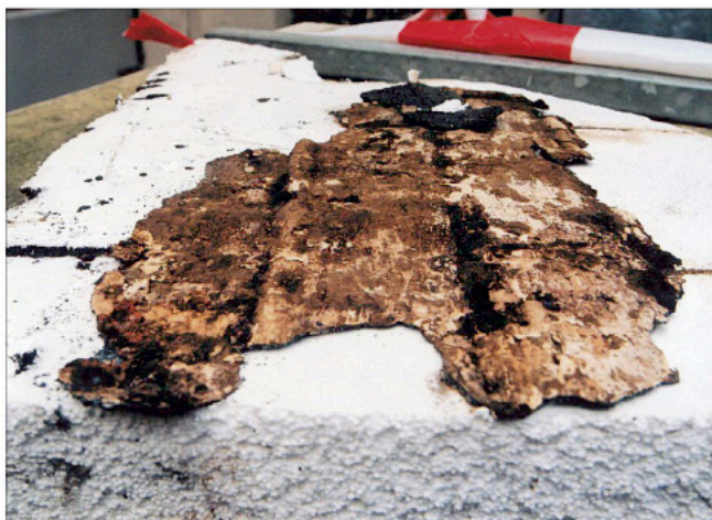
Abb. 3: Schmutz und lose Bestandteile an der Haftseite der KMB
