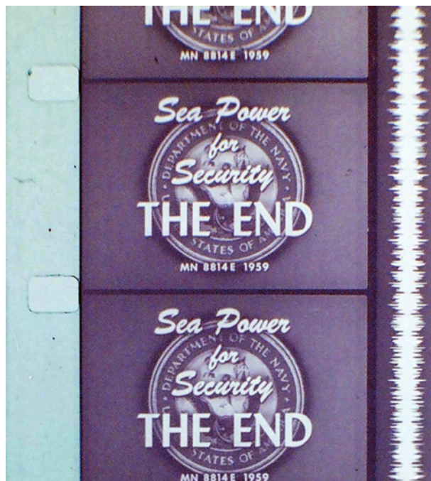
Abb. 33 16-mm-Filmmaterial. Die Perforation geht über den Bildstrich.
