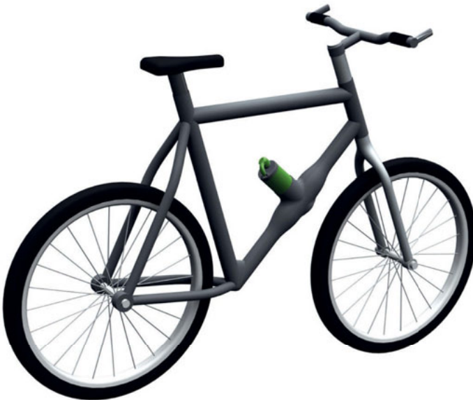
Abbildung 6-9: Fertigungsintegrierende Produktlösung 4.1 für einen innenhochdruckumgeformten Fahrradrahmen mit integriertem Flaschenhalter
