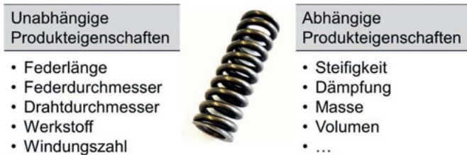
Abbildung 2-7: Unabhängige und abhängige Produkteigenschaften einer Schraubenfeder
