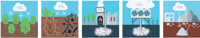
Abbildung 1: Fünf Methoden zur Entnahme von CO 2 aus der Atmosphäre: Waldmanagement mit Holzverwendung, Bodenmanagement mit Pflanzenkohle, Bioenergy Carbon Capture and Storage (BECCS), Direct Air Carbon Capture and Storage (DACCS) sowie Carbonatisierung mit beschleunigter Verwitterung (Quelle: Cames et al. 2023)
