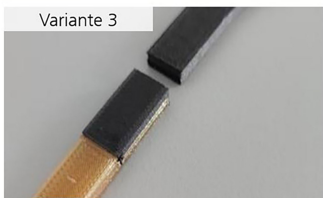
Bild 5. Charakteristisches Bruchbild der unterschiedlichen Verbindungsvarianten (schwarz: fasergefülltes Material, goldbraun: ungefülltes Material). Grafik: Fraunhofer IPA
