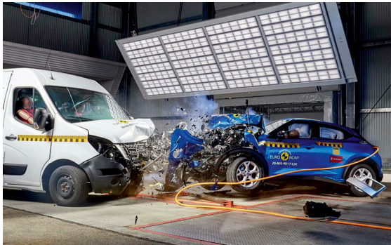
Abb. IV.4: ADAC Unfalltest nach NCAP-Standard (European New Car Assessment Programm) Quelle: ADAC/Uwe Rattay
