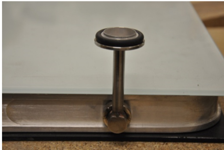
Abbildung 2.13: Evakuierungsstutzen für die Evakuierung des VIGS während der Herstellung bzw. für den Fall einer Re-Evakuierung
