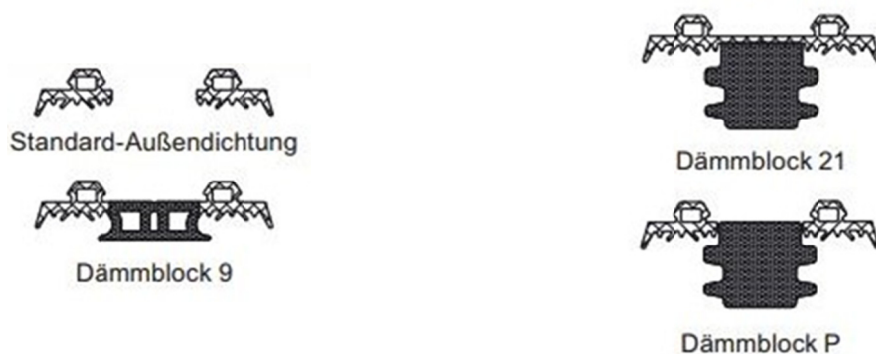
Abbildung 2.19: Dämmblock Varianten für ein thermisch optimiertes Pfosten-Riegel-System [28]
