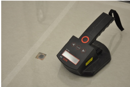
Abbildung 2.16: Drucksensor im VIGS und Transponder des Fraunhofer Instituts
