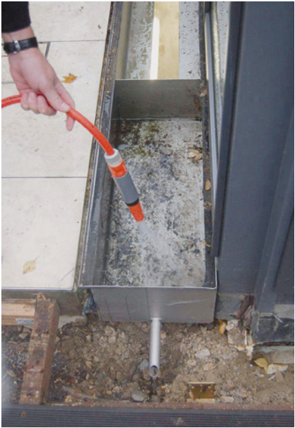
Abb. 3.7.4: Entwässerungsrinne mit separatem Ablauf, Bewässerungsversuch
