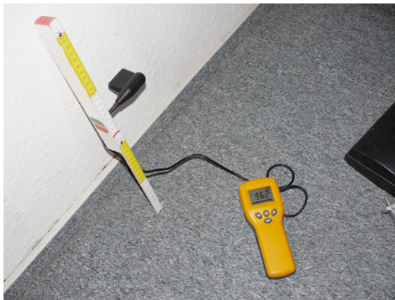
Abb. 3.13.1: Exemplarische Messung der Materialfeuchte an einer Innenwand
