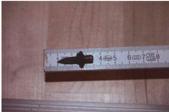
Abb. 3.3.6: Entnommener Befestigungsnagel zur Befestigung der Heizleitungen
