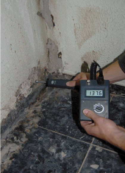
Abb. 3.11.5: Exemplarische Feuchtemessung an einer Kelleraußenwand
