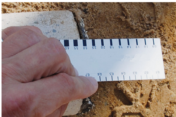
Abb. 3.14.4: Messung der Schichtdicke am Bohrkern
