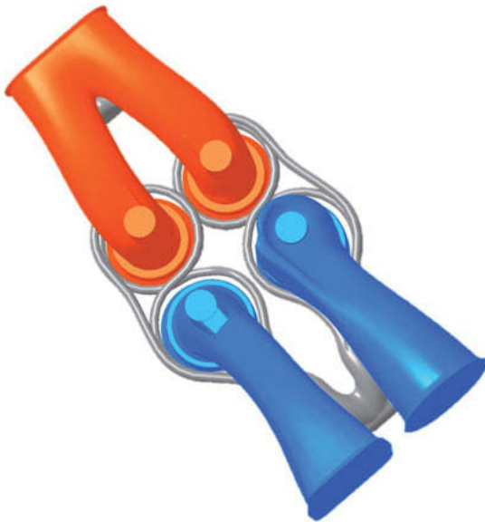
Bild 10: Wassermantelkonzept für die Brennraumkühlung
