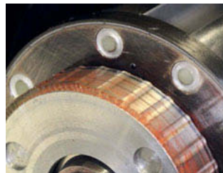
Bild 4: Profilierter Elastomerring zur niedersteifen Anbindung des Rotors
