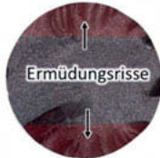
Bild 4: Bruchbild mit hochbeanspruchten Zonen
