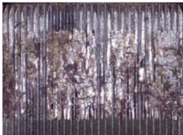
Bild 7: Schadensfall nach statischer Belastung, links: Welle 18CrNiMo7-6, rechts: Nabe C45 ( t = 0,5 mm, U_{\text{geo}} = 0,33 mm, l_F = 6 mm, D_A = 60 mm, Q_A = 0,5 , \phi = 15^\circ )
