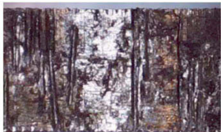
Bild 7: Schadensfall nach statischer Belastung, links: Welle 18CrNiMo7-6, rechts: Nabe C45 ( t = 0,5 mm, U_{\text{geo}} = 0,33 mm, l_F = 6 mm, D_A = 60 mm, Q_A = 0,5 , \phi = 15^\circ )
