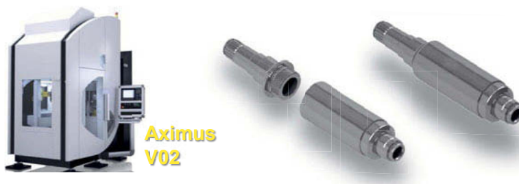
Abbildung 4: Validierung – Probenherstellung mittels Aximus V02 (links) und Probe (rechts)
