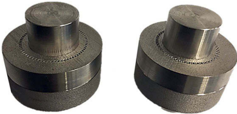
Bild 7: Gefügte Pressverbände mit teilweise abgedrehten Naben für genauere Durchmesser-messungen
