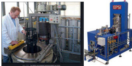
Bild 1: HIP mit Gewinde- und Rahmenverschluss
