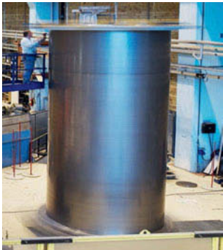
Bild 2a: Druckgefäß bereit zum Drahtwickeln (Quelle: Quintus, Schweden)
