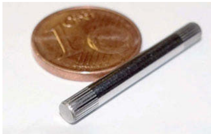
Bild 6: Gerändelte und überschleifene Antriebswelle mit 3 mm Durchmesser
