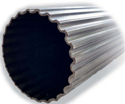
Bild 1: Aus einem Rohr umformend hergestellte, dünnwandige Profilwelle als Beispiel für eine Möglichkeit der Tragfähigkeitssteigerung bei geringerem Gewicht.
