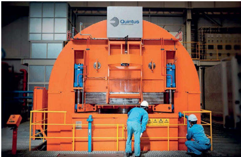
Bild 2b: Drahtgewickelte HIP-Anlage (Quelle, Quintus Schweden mit freundlicher Genehmigung von MTC)
