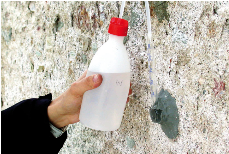
Bild 2: Bestimmung der Wasseraufnahme eines Putzes an der Fassade mittels Karsten'schem Röhrchen
