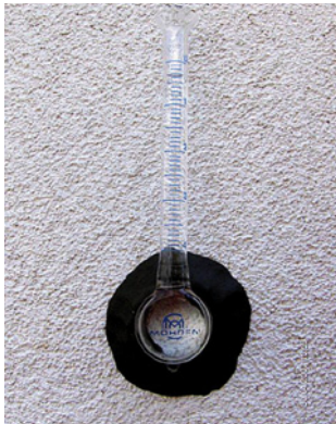
Bild 17: Test am Bau mit Karstenschem Röhrchen
