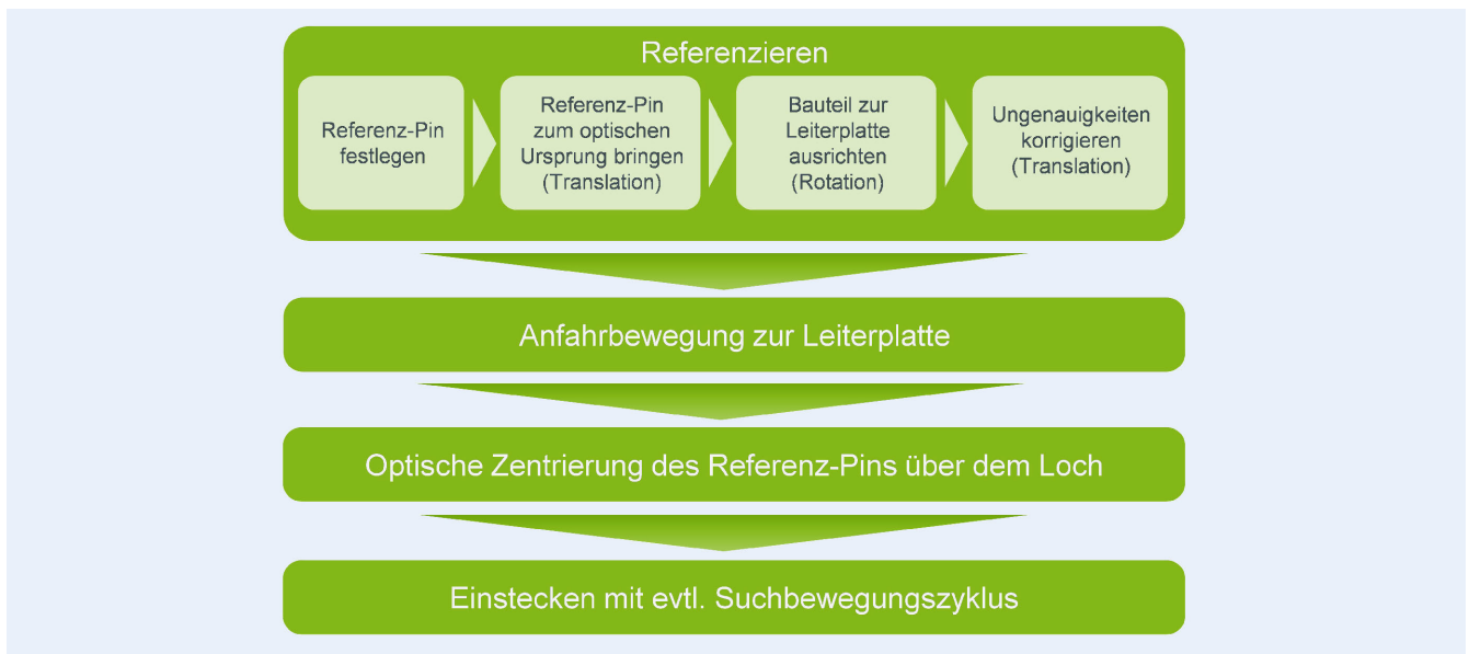
Bild 3. Steuerungsablauf der intelligenten THT-Bestückung. Grafik: IPS
