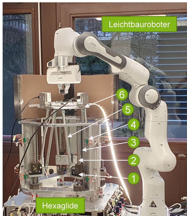
Bild 1. Montagesystem bestehend aus dem Hexaglide und einem Leichtbauroboter: 1 – Spindelwinkel, 2 – Gewindespindel, 3 – Gleitschiene, 4 – Endschalte, 5 – Stange mit Kugelgelenken, 6 – Plattform.
