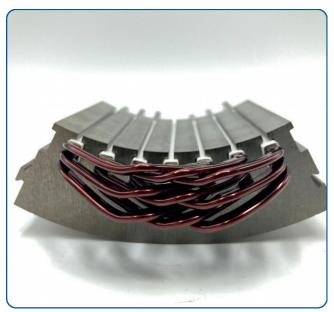
**Bild 9.** Abstrahierter "Statorette"-Prüfkörper zur anwendungsorientierten Systemprüfung. *Grafik: PEM RWTH Aachen*
