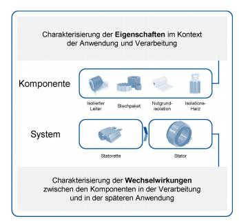
Bild 3. Darstellung der unterschiedlichen Betrachtungsebenen und Zielsetzungen der anwendungsorientierten Prüfung. Grafik: PEM RWTH Aachen
