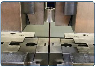
Messung der Anhaftung der Imprägnierung
