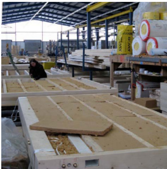
Abbildung 24: Werkstraße zur Produktion von Wand- und Dachmodulen
