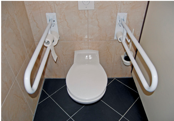
Bild 66 ■ WC für Rollstuhlnutzer mit seitlich angeordneten Stützklappgriffen
