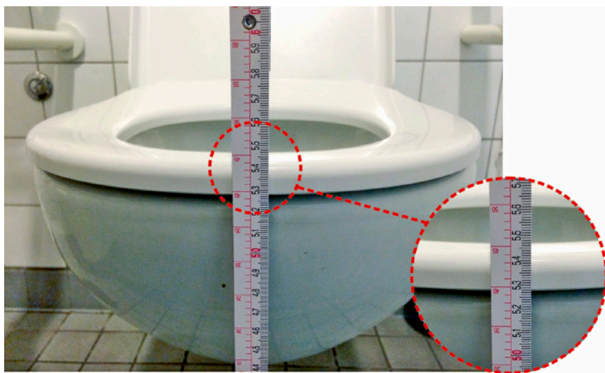
Bild 48 ■ Messung der Sitzhöhe an dem WC
