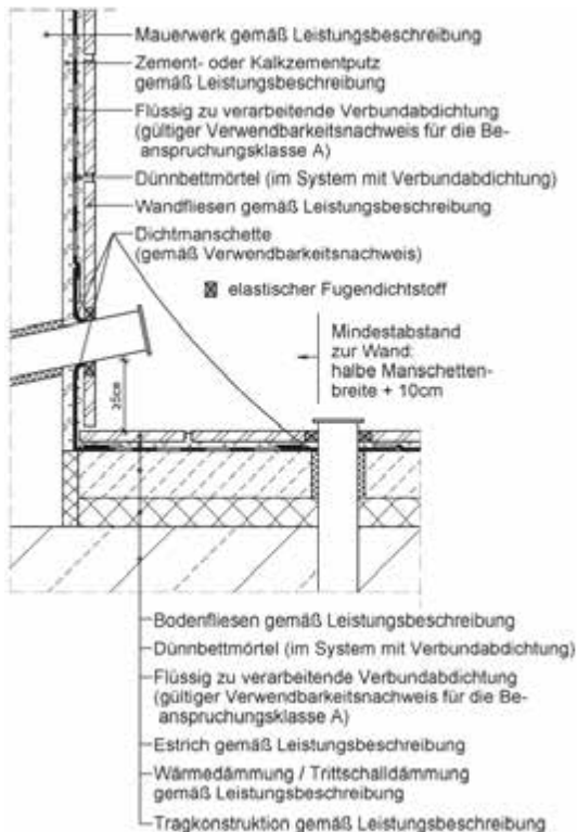
Abb. 14: Anschlüsse an Rohrdurchdringungen, zum Beispiel unterhalb von Bade- oder Duschwannen
