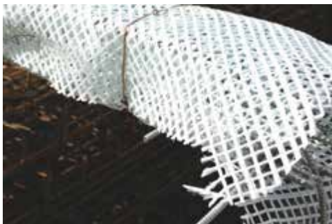
Bild 10: mit AR-Glasgelege umwickelte Edelstahl-Querträgerbewehrung (Foto: Harald Michler)
