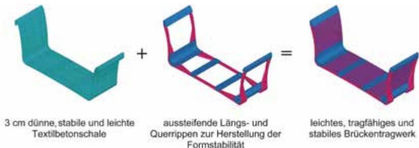
Bild 9: Schematischer Aufbau der Segmente der Textilbetonbrücke in Kempten (Quelle: Harald Michler)
