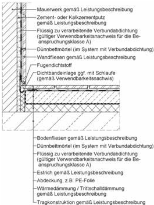
Abb. 10: Ausbildung des Estrichrandanschlusses bei flüssig zu verarbeitenden AIV (nach [ZDB 01, 2012])
