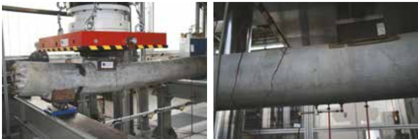
Bild 7: Prüfung eines Referenzmastes (links) und eines verstärkten Stahlbetonmastes (rechts), (Foto: Ammar Al-Jamous)
