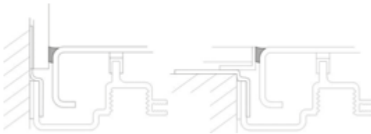
Abb. 18: Oberseitige Versiegelung des Zwischenraumes von Fliesenbelag und Duschwanne (System Kaldewei ESR)
