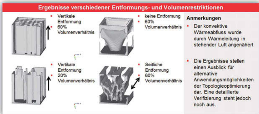
Bild 4: Topologieoptimierung in Verbindung mit Wärmeleitproblemen
