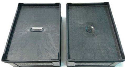
Bild 2: Die analysierten Musterteile, links mit FDU, rechts mit offener Düse
