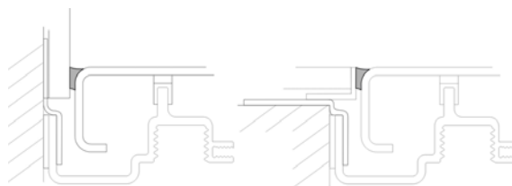
Bild 18: Oberseitige Versiegelung des Zwischenraumes von Fliesenbelag und Duschwanne (System Kaldewei ESR)
