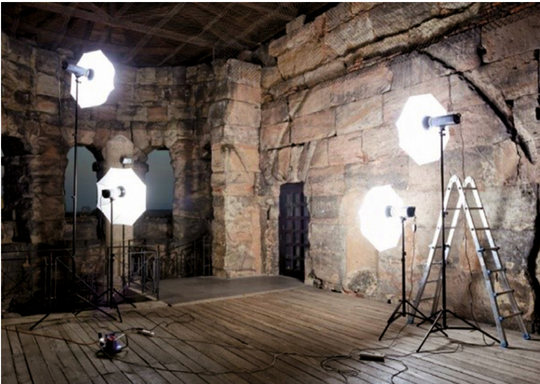
Bild 2 Trier, Porta Nigra, Einsatz von Kunstlicht bei der Aufnahme von Wand- abwicklungen
