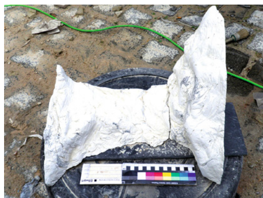
Bild 23 Gipsmodell mit Trennschicht
