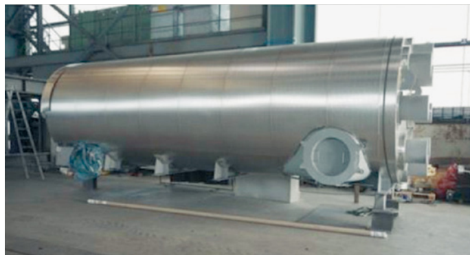
■ Abb.93: Mobiler Adsorptionsspeicher isoliert und mit Zeolith befüllt
