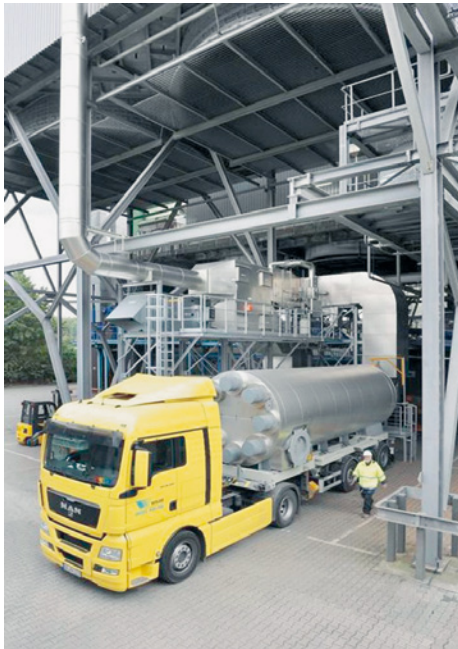
■ Abb. 116: Mobiler Sorptionsspeicher an der Ladestation
