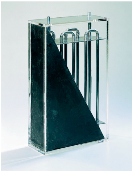
■ Abb. 114: Wärmeübertrager mit Graphitmatrix und Natriumacetat als Phasenwechselmaterial.
