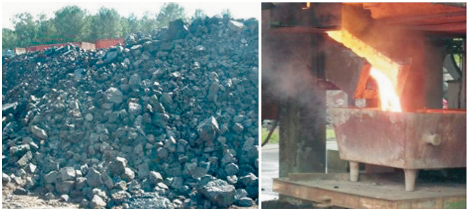
■ Abb. 109: Asbest-Abfall und Verglasungsprozess
