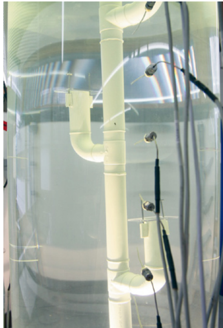
■ Abb.63: Prototyp des neuen Schichtladers im Modellmaßstab auf dem Speicherteststand
