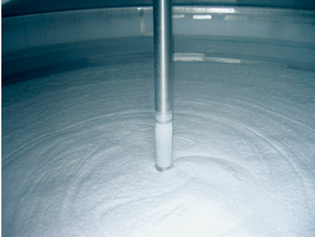
■ Abb. 79: Anlage zur Erzeugung von Eis-Slurry, Brauerei Zipf
