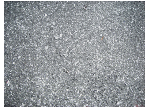
Bild 10 Links: Siebanalyse von im Querstromzersetzer gemahlene Spänen. Rechts: Im Querstromzersetzer gemahlene Späne, größte Partikel circa 2 mm Durchmesser. Grafik und Foto: Fraunhofer IWU
