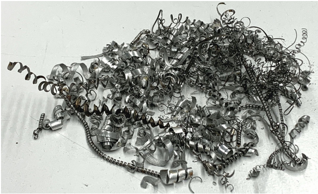
Bild 9 Aluminiumlegierungsspäne für die Zerkleinerung im Querstromzersetzer, Bildbreite 12 cm. Foto: Fraunhofer IWU
