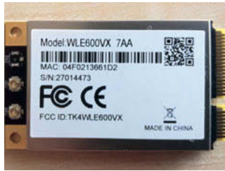
Abbildung 5.4: WLAN-Modul nach IEEE802.11b,n
