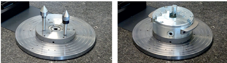
Bild 24: Drehtischspitzeneinheit – links: Wechselspitzen, rechts: Backenfutter
