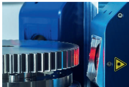
Abbildung 2: Digital-holographisches Messsystem HoloGear: Zwei Messköpfe, die mit derselben Laserquelle verbunden sind, messen gleichzeitig die linke und rechte Flanke eines Zahnradprüflings.
