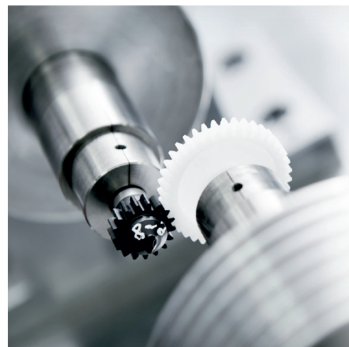
Bild 1: Prüfverzahnung nach VDI 2736 (Baugröße 1), hergestellt und getestet bei SCHOLZ
