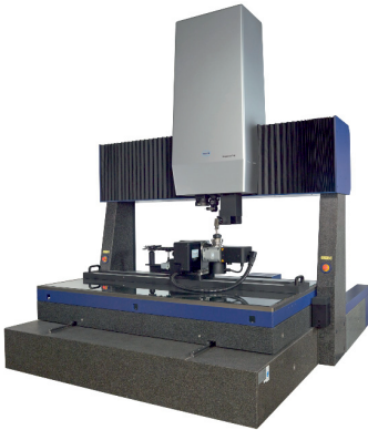
Bild 2: Werth ScopeCheck® FB mit drei unabhängigen Sensorachsen für Multisensor-Messungen mit Bildverarbeitung und Werth Zoom (links), konventionellem Taster am Dreh-Schwenk-Gelenk (Mitte) und Chromatic Focus Line Sensor (rechts)
