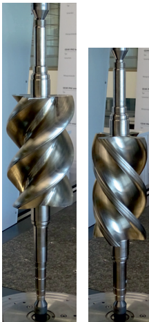
Bild 10: Schraubenverdichterpaar – links: „male“, rechts: „female“
