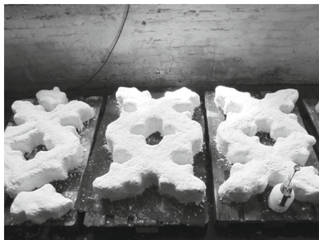
Abb. 23: Aufbringen der Zellstoffkompressen nach der Behandlung im Wasserbad
