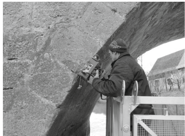
Abb. 6: Radarmessung der Stirnflächen
