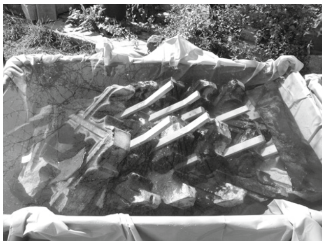
Abb. 22: Salzreduktion im Wasserbad in einem mit Folie ausgekleidetem Container
