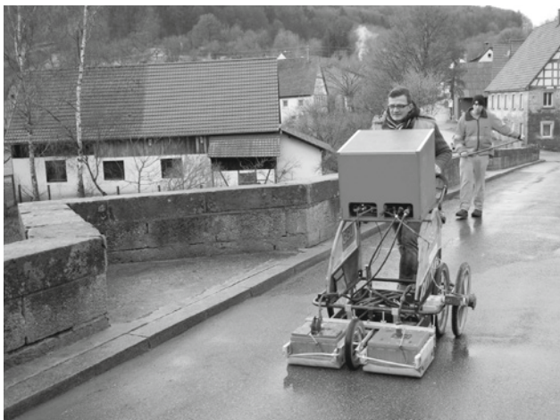
Abb. 5: Radarmessung von der Straße
