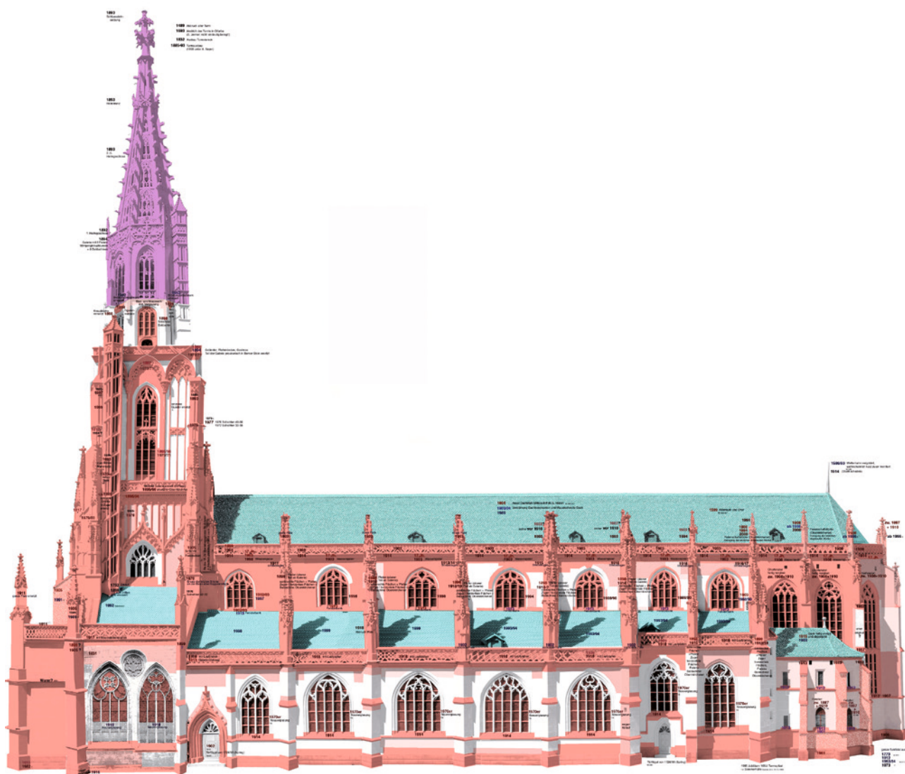
Abb. 9: Bestand an originalen äußeren Bauteilen am Beispiel der Südfassade: Sämtliche rot markierten Bereiche wurden seit der Turmaufstockung Ende 19. Jahrhunderts erneuert (Erfassung 2001 auf Fotos des Münstermodells „Swissminiature“)
