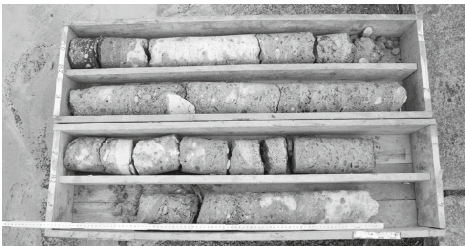
Abb. 14: Bohrkern B2 im Bohrkasten mit Abschnitten von der Oberfläche (Asphalt) bis ca. 3,5m Tiefe
