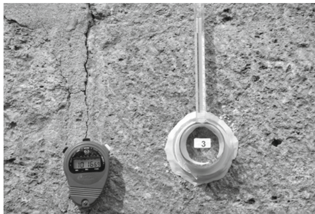
Abb. 12: Wasseraufnahmemessung mit dem Kars-tenschen Prüfröhrchen nach WTA Merkblatt 3-17:06.2010/D [8]
