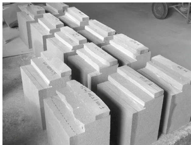
Abb. 5: Um eine möglichst objektive Vergleichbarkeit der unterschiedlichen Festigersorten zu erhalten, wurden auch Versuche an unverwittertem Material vorgenommen. Die blaue Linie zeigt jeweils die Eindringtiefe des Festigers.
