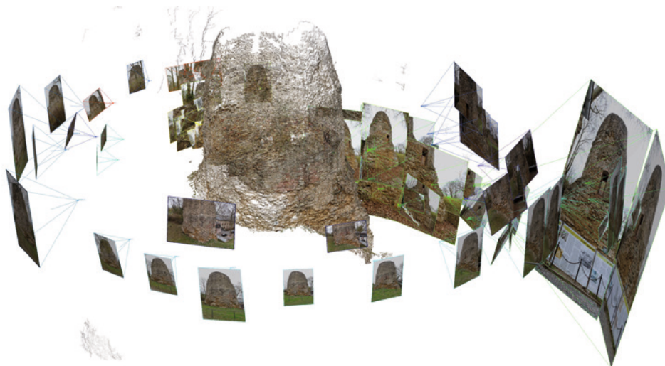
Abb. 1: Aufnahmeserie und photogrammetrisch berechnete Punktwolke am Drususstein
