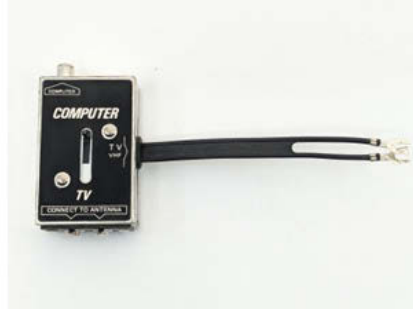
Abb. 8: Parasitäre Signaleinspeisung. Grafik aus Serres' »Der Parasit« (links), T-Weiche für den Anschluss des Heimcomputer-HF-AV-Signals an den Fernseher (rechts)
