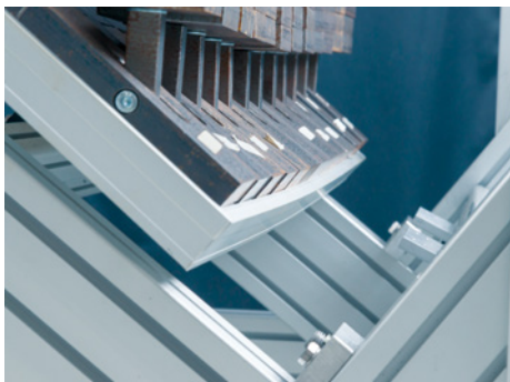
Abb. 91: Links: Inhomogene Lastprüfung auf geneigten Modulen am Modulrahmen, rechts: Rahmenverformung durch Schneeanhäufung an Rahmenkante
