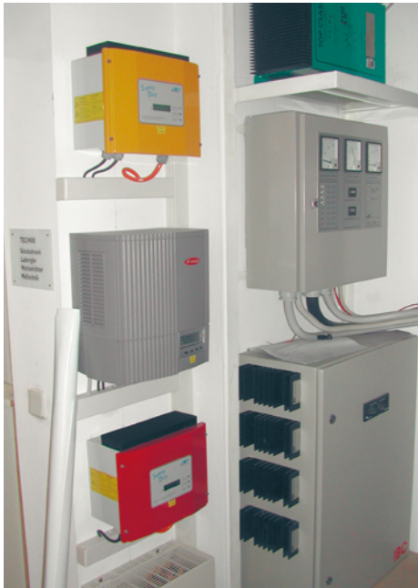
■ Abb. 50: Unterschiedliche Wechselrichter-typen im Test beim SOLID in Fürth
