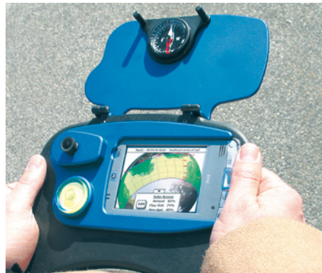
■ Abb. 35: Schattenanalysegerät SunEye mit Kamera und PDA mit Auswertesoftware zur Vortauswertung
