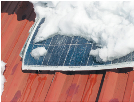
■ Abb. 92: Links: Glas- und Rahmenbruch durch Schneelast, rechts: Rahmenrückhalter »Framefix«
