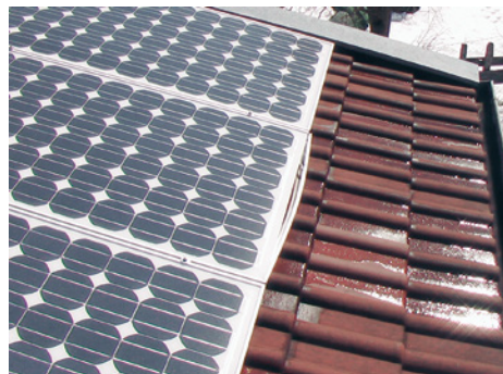
Abb. 91: Links: Inhomogene Lastprüfung auf geneigten Modulen am Modulrahmen, rechts: Rahmenverformung durch Schneeanhäufung an Rahmenkante
